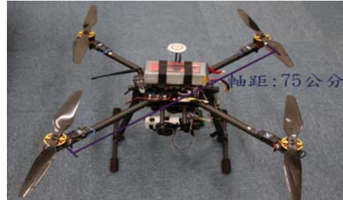
圖 1 自行組裝四軸無人飛行載具
