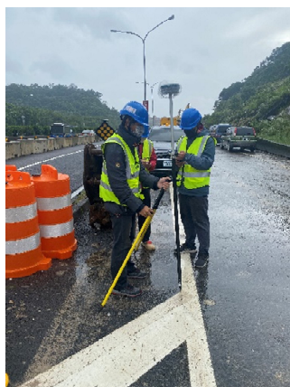
圖 5 控制測量作業
