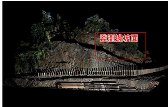
圖 22 地面光達掃描坡面位置與基準面點雲(111.11.08)
