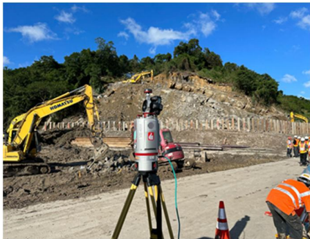
圖 22 地面光達掃描坡面位置與基準面點雲(111.11.08)
