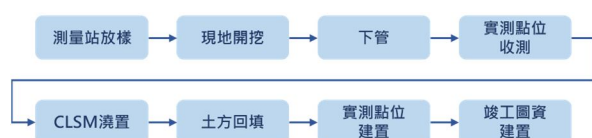
圖 6 管線實測作業流程
