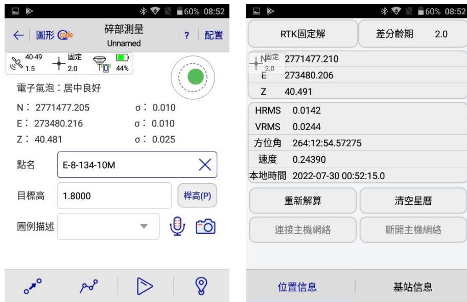
圖 8 3D 管線實測點位照片範例(GNSS 測量儀器畫面截圖)
