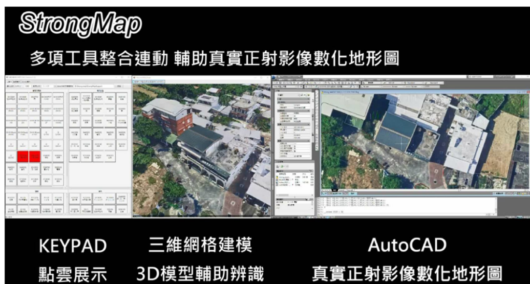
圖 20 使用 3D 模型輔助真正正射影像繪製地形圖
